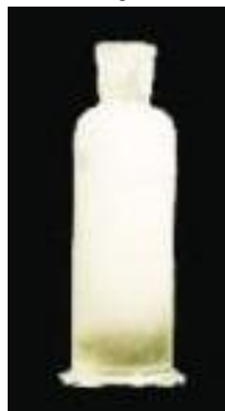
Bild 2: Kvävgasövermättat uppvärmningsvatten efter provtagningen
